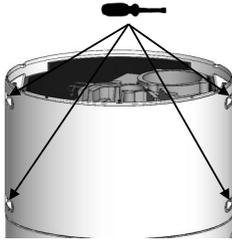
4 Verwijder de afdekkingen en draai de 4 schroeven op het voordeksel van de warmtepomp los.
