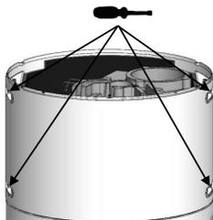
**4** Rimuovere i copriviti e svitare le 4 viti del coperchio anteriore della pompa di calore.
