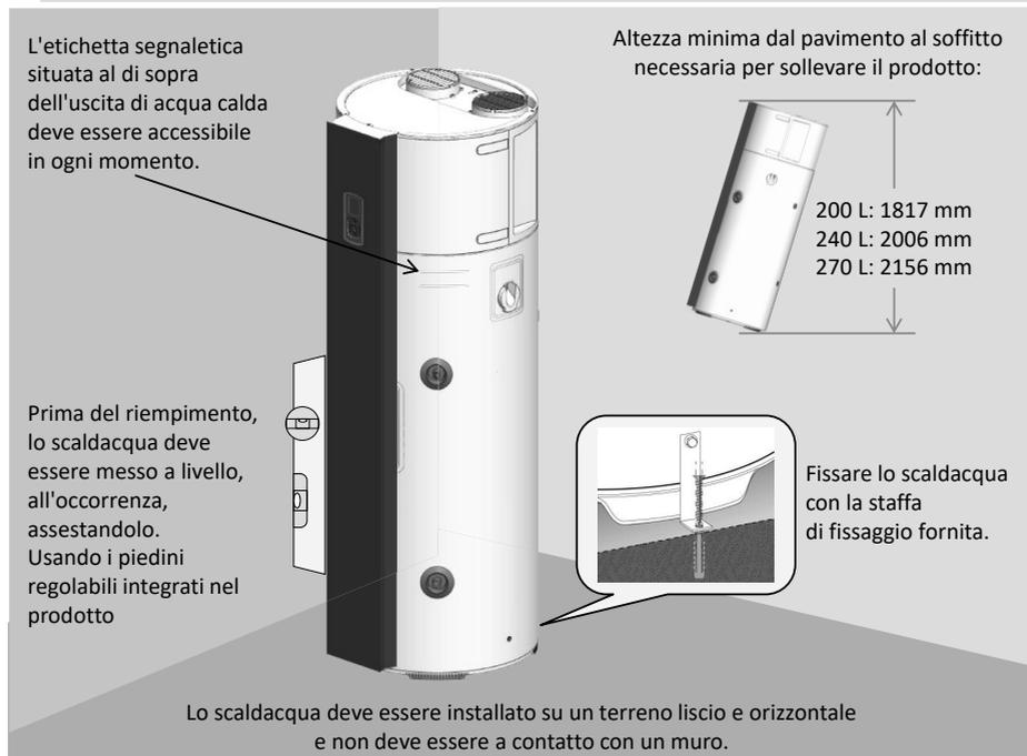
**Lo scaldacqua deve essere obbligatoriamente fissato a terra (conformemente all'articolo 20 della norma EN 60335-1) per mezzo dell'apposita staffa di fissaggio.**
